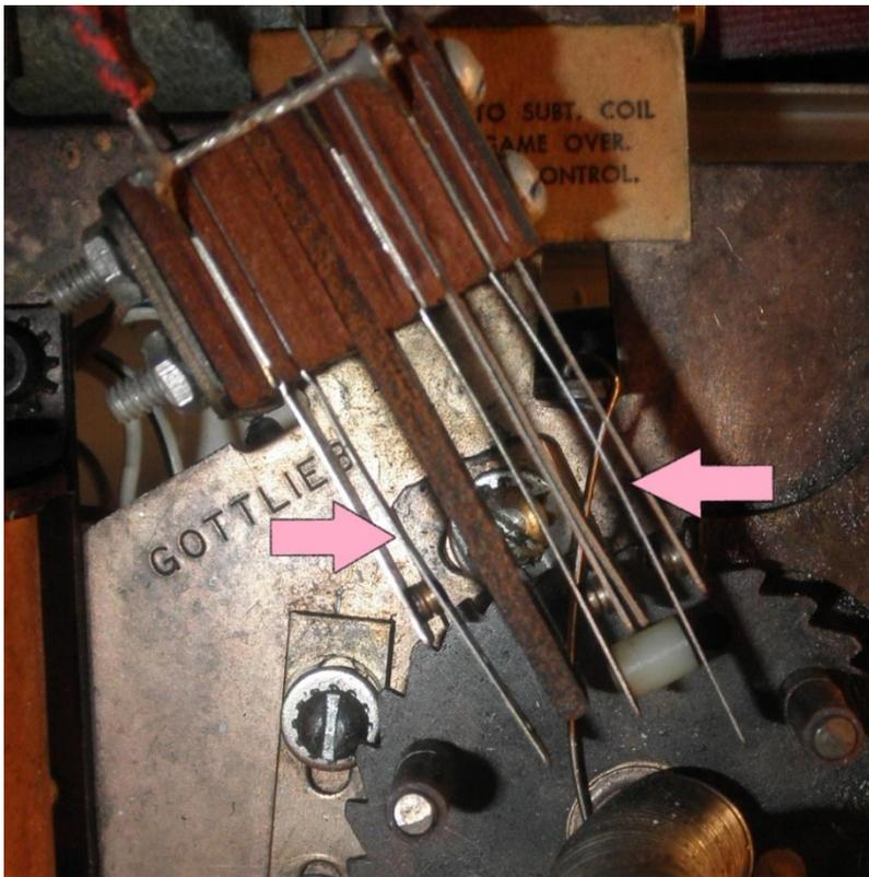
Abbiamo spiegato che nel retro del contatore ci sono due coppie di lamelle (indicate con le frecce rosa) chiuse che si aprono allo 0 e a 6 palle. Esse prendono corrente dal piano motore e la portano al piano gioco.
